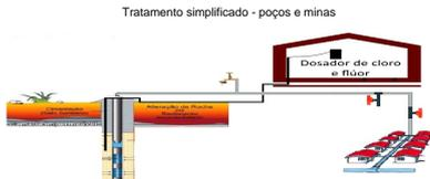
Os reservatórios são lavados e higienizados periodicamente, no sistema de distribuição e são executadas descargas periódicas para assegurar que a água distribuída não sofra alterações da qualidade.
